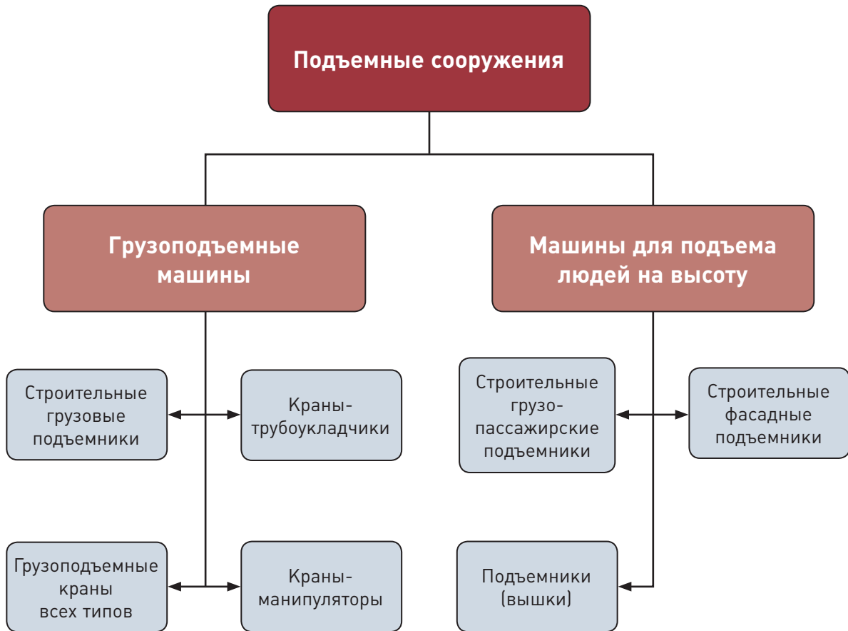
Рис. 1. Виды подъемных сооружений
